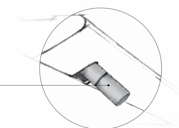
Sicura sbloccata, possibilità di ruotare il piano fino a 180°
